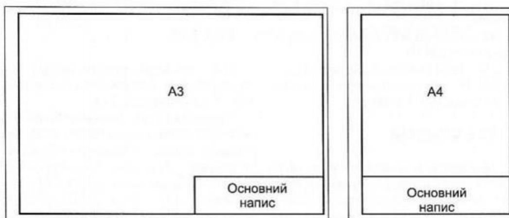
Рис. Д.2 – Розміщення основного напису на форматах
