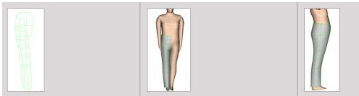
Рис. 12.3 – Перегляд отриманого виробу в каркасному та твердотільному вигляді та корекція заданої форми
