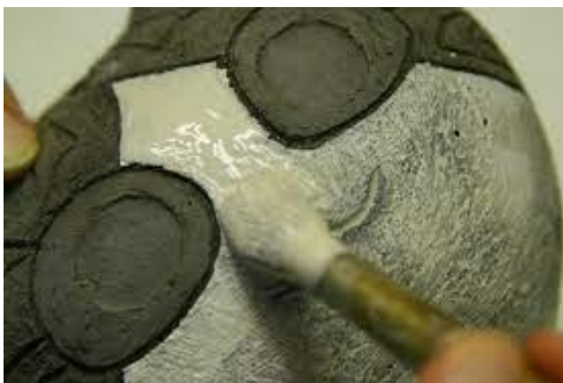
Рисунок 15. Заповнення (обмазування) площі виробу ангобом
