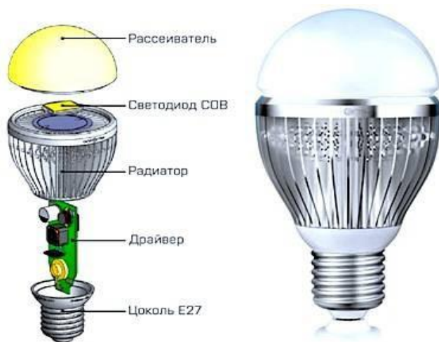
Рисунок 5.7 – Схема світлодіодної електричної лампи та її форма
