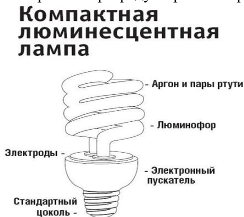
а) б) Рисунок 5.3 – Схема електричної люмінесцентної лампи (а) та її основні форми (б)
