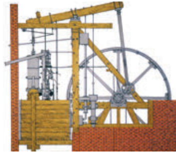
Рис. 17.1. Парова машина Ватта
