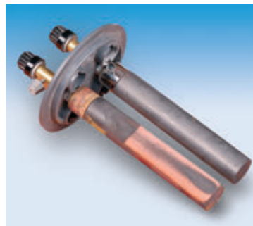
Рис. 37.5. Через кілька хвилин після початку пропускання струму через розчин купрум(II) хлориду поверхню катода вкриє тонкий шар міді
