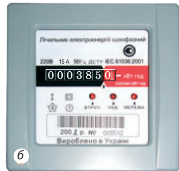
Рис. 33.1. Зняття показів лічильника: а — початкові дані (382 кВт·год); б — дані лічильника після деякого часу роботи електрообігрівача (385 кВт·год). Кількість використаної за цей час електроенергії: 385 - 382 = 3 (кВт·год)
