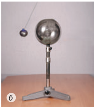
Рис. 21.3. Електризація сфери через вплив (а); індикатором наявності заряду слугує позитивно заряджена повітряна кулька — вона відхиляється від сфери, отже, сфера (на відміну від палички) заряджена позитивно (б)
