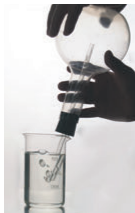
Рис. 2.1. Нагріваючись, повітря в колбі розширюється, і деяка його частина виходить із колби — біля отвору трубки утворюються бульбашки повітря
