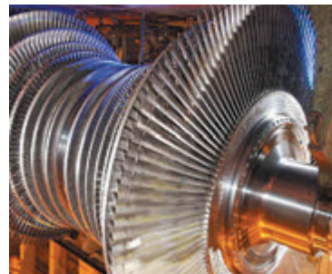
Рис. 17.3. У сучасних турбінах для максимального використання енергії пари застосовують кілька дисків з лопатями, які насаджено на один спільний вал
