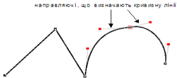
Рис.11.2 – Побудова контуру з прямолінійними та криволінійними ділянками
