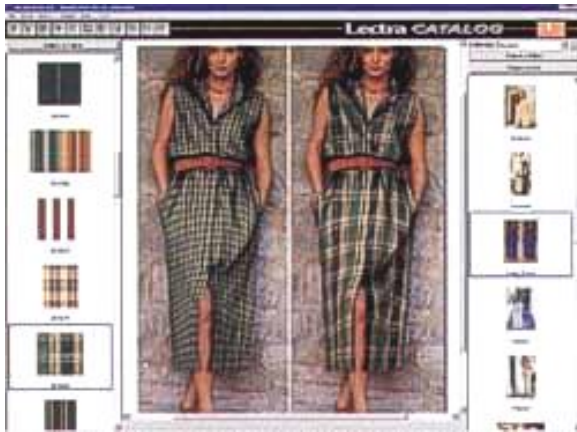
Рис.7.1 – Примірка моделей на віртуальних манекенах в САПР «Lectra»
